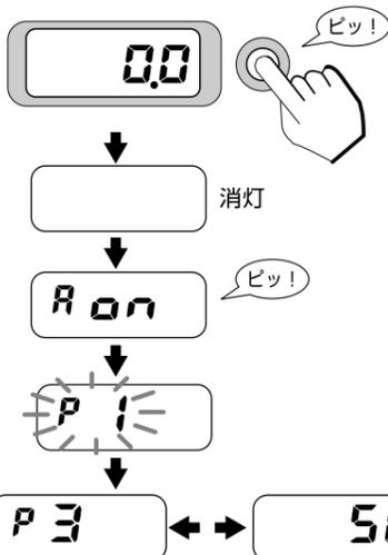
**2** スイッチを2回押しして、**P3** (引出し入力) 画面にしてください。**P3** と **50** が順番に点滅し、引出し入力画面になります。
