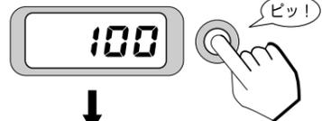
**8** スイッチを設定したい長さになるまでくり返し押しして道糸の長さをセットします。(図は、200m入力した場合です。)
