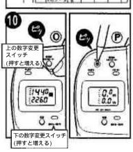
(0) (リセット) ボタン (上の 数字変更用)と(セット) ボタン(下の数字変更用) を押して、確認したデータの数字に画面表示を合 わせます。
