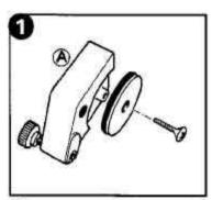
(A) まず、ネジをゆるめて「速 攻スケール」からローラ ーを取り外してくださ
