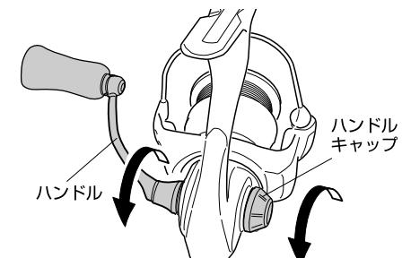
3 ④新しく取り付けるハンドル側へ防水パッキンを移動し取り付けます。
