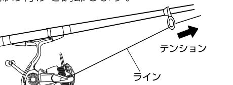
※遠投する際には、ドラグが滑ると糸で指を傷つけるおそれがあります。必ずドラグをよく締め付けてから投げるようにしてください。
