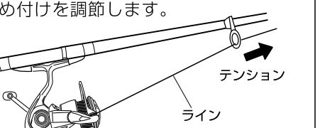
※遠投する際には、ドラグが滑ると糸で指を傷つけるおそれがあります。必ずドラグをよく締め付けてから投げるようにしてください。
